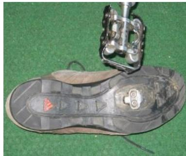
**Photo 2 :** Un exemple d'un système de pédales à clip. La cale peut s'accrocher de chaque côté de la pédale.
